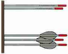
Si les flèches nues sont au dessus des empennées, le repère d'encoche est trop bas. Il faut le monter.
