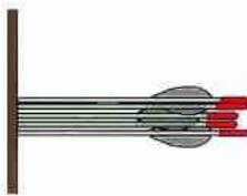
Le détalonnage est bon si les 3 flèches non empennées sont dans le même groupe que les 3 flèches empennées.
